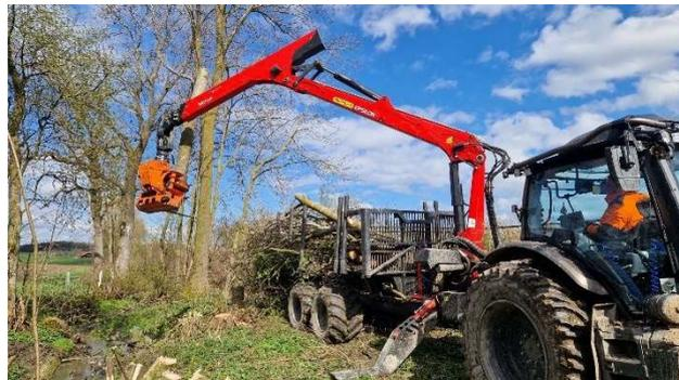
Unser Mitglied Stefan Wagner aus Unterschwendt hat seinen Rückwagen mit einer Greifersäge aufgerüstet. Die Greifersäge eignet sich optimal für Durchforstungsarbeiten, Straßenbegleitgrün und Kurzumtriebsplantagen. Die Greifersäge geht bis max. 54 cm Durchmesser, die Kranreichweite beträgt 10 m. Tel: 0160/95472550.
