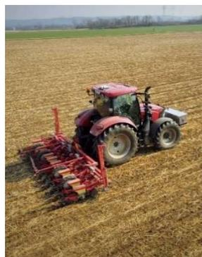
Markus Wackerbauer aus Ergolding bietet sein 12-reihiges Einzelkorn-Sägerät für den überbetrieblichen Einsatz bei der Zuckerrüben- und Rapsaussaat an. Mit RTK Spurführung, Section Control, Mulchsaat geeignet.
